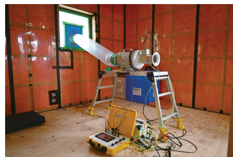
住宅の相当隙間面積を専用測定器によって計測している様子。(気密測定は工事完了時に加え、気密施工不良箇所の確認や計測後の手直しが可能なよう、断熱・気密工事了時の2回の実施が望ましい。)
